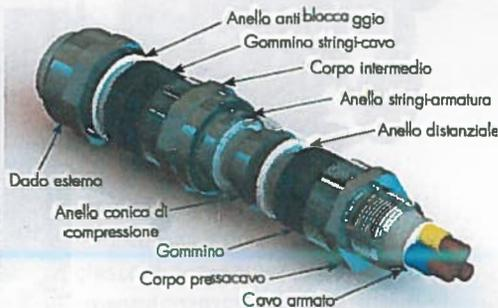
**STRUTTURA DI UN PRESSACAVO PER CAVO ARMATO**
