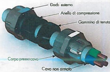
**STRUTTURA DI UN PRESSACAVO PER CAVO NON ARMATO**
